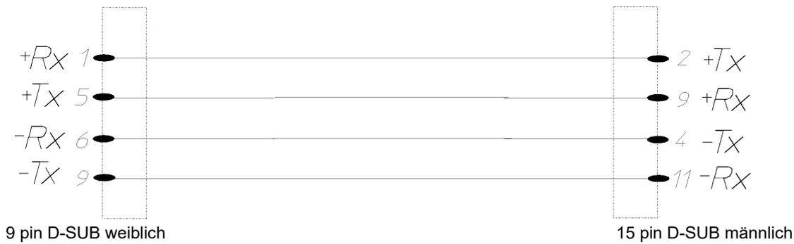
Abb. 4-11 Steckerbelegung Schnittstellenkabel RS 485 bei Anaprog-Regler
