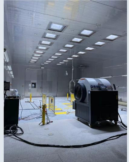
**Gewähltes Produkt:** Klimaprüfkammer für Rollenprüfstand
