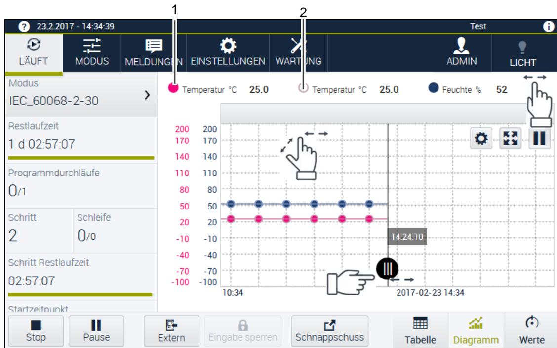
Abb. 3-7 Menü LÄUFT – Ansicht Diagramm im Programmbetrieb
