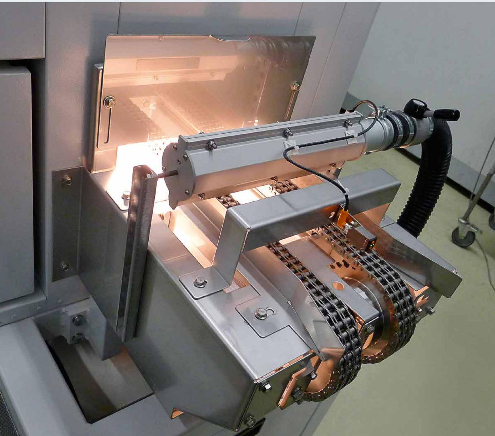
**Infrarot-Ofen VDIR 30/10/100-200 °C für das Trocknen von Tellerfedern nach dem Schleifen und Waschen**
