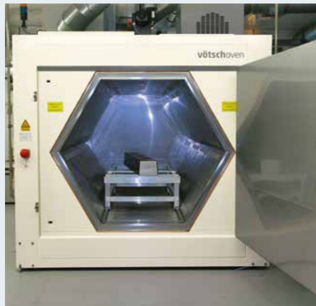
Aushärtungssystem VHM 180/300 für CFK-Strukturen in der Luftfahrt
