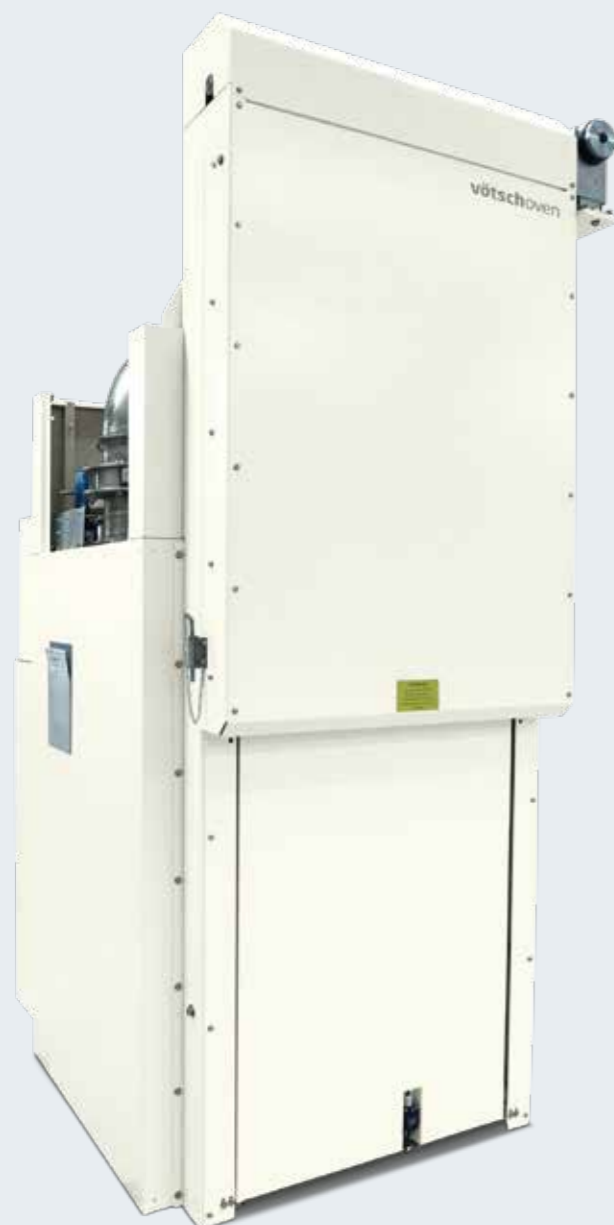
Kammerofen VTU 75/100-G-200 °C zum Vernetzen von Kontaktlinsen unter Schutzgasatmosphäre
