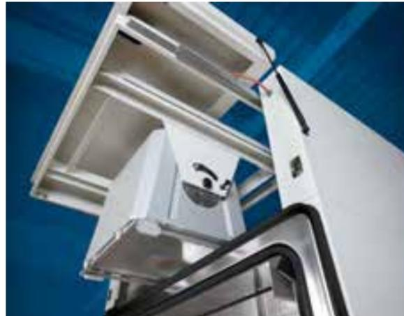
So können unter Laborbedingungen deren Auswirkungen auf den Prüfling untersucht und die Alterung durch Sonneneinstrahlung, Temperatur und Feuchtigkeit bestimmt werden. Das ermöglicht reproduzierbare Messungen unter definierten, kontinuierlichen, tages- und jahreszeitunabhängigen Bedingungen.
