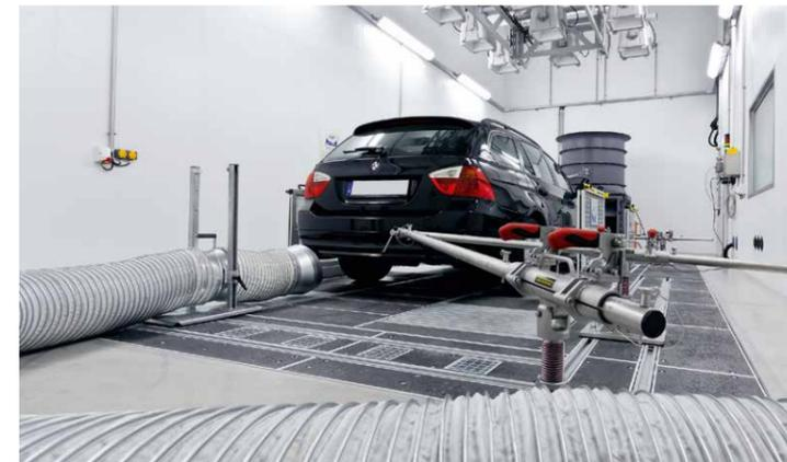
ermöglicht sie die Sonnensimulation mit bis zu 1000 W/m<sup>2</sup>. Auf dem Prüfstand erzeugt ein Fahrtwindgebläse Wind mit einer Geschwindigkeit von bis zu 120 km/h, proportional zur simulierten Fahrgeschwindigkeit.
