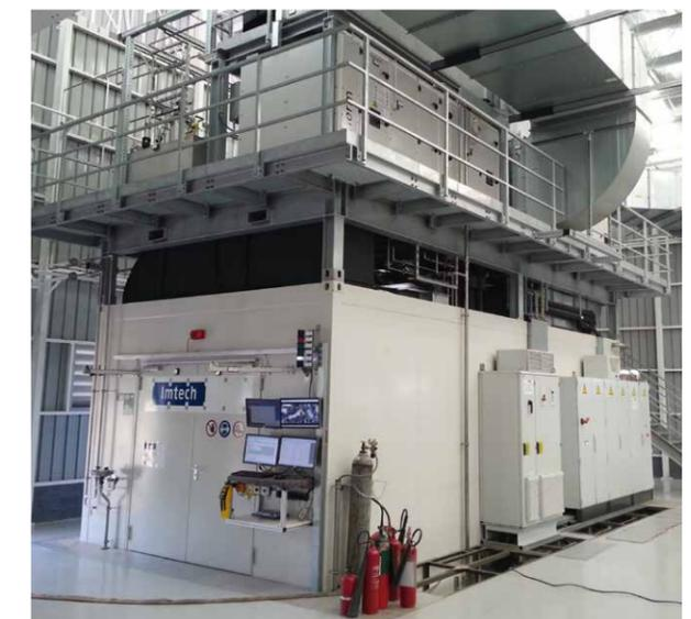
Prüfstands-Modul mit aufgeständertem Versorgungsrahmen
