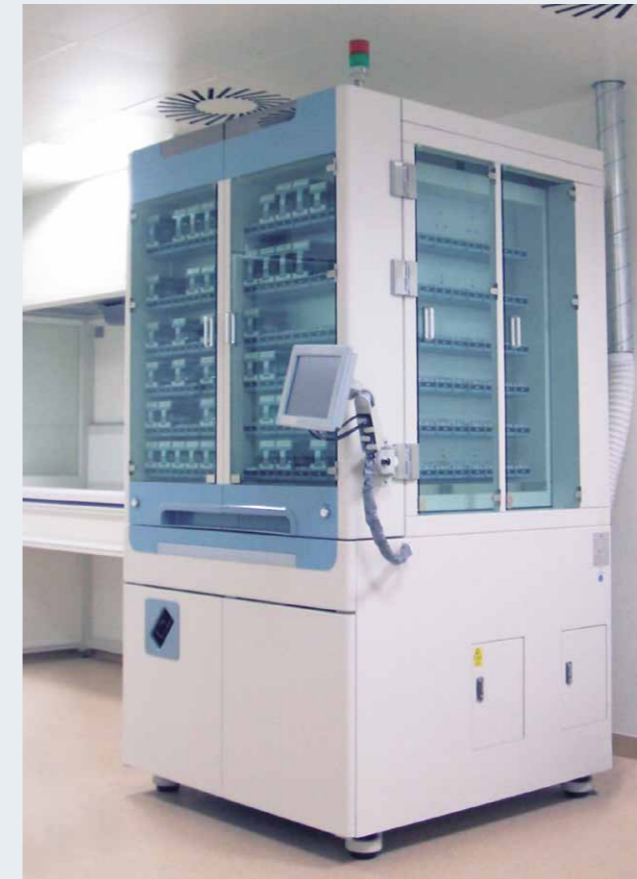
GMP-Reinraum mit Blisterautomat und Entblisterarbeitsplatz
