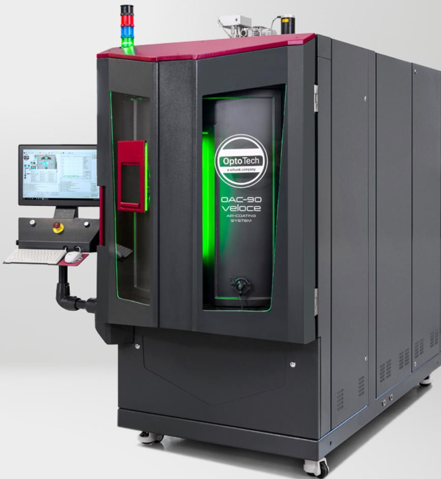
Die OptoTech's Beschichtungsmaschine OAC-90 Veloce wird zum Auftragen von hochwertigem Antireflex-Beschichtungen (AR) und sogenannten Clean Coats (CC) auf ophthalmischen Linsen verwendet. Das OAC-Beschichtungssystem zeichnet sich durch die für OptoTech bekannte Produktqualität, einfache Handhabung und Zuverlässigkeit im täglichen Produktionsbetrieb aus.
