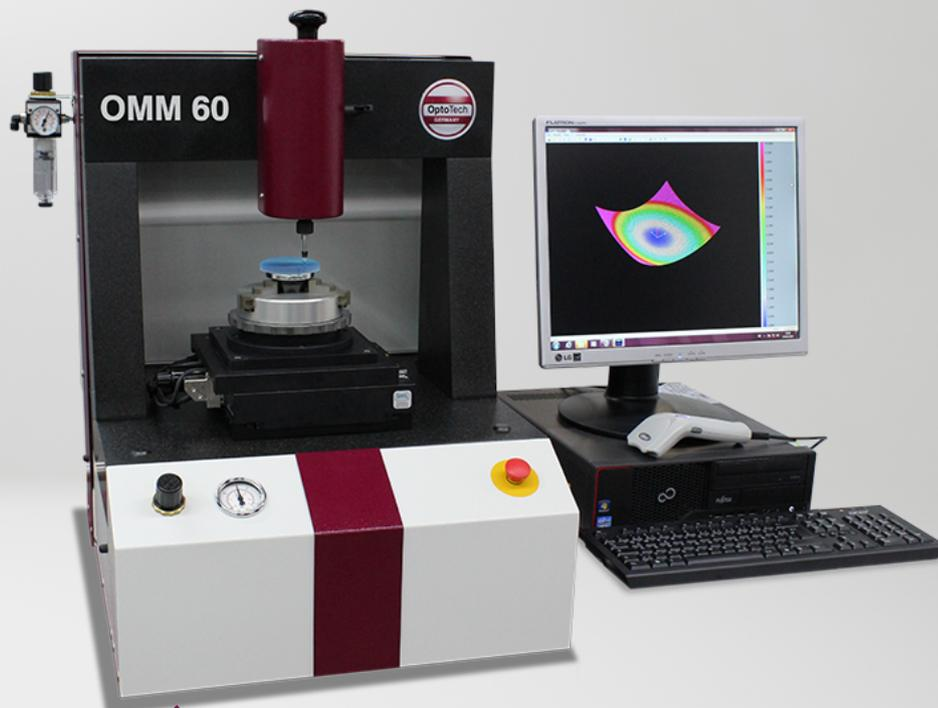
Die neue preiswerte Freiform-Messmaschine OMM 60 ist ein unverzichtbares Werkzeug für die Qualitätsprüfung in Herstellung von Freiformgläsern. Die OMM 60 kann konvexe und konkave Linsen sowie geschliffene Gläser messen und polierte Oberflächen ausmessen.
