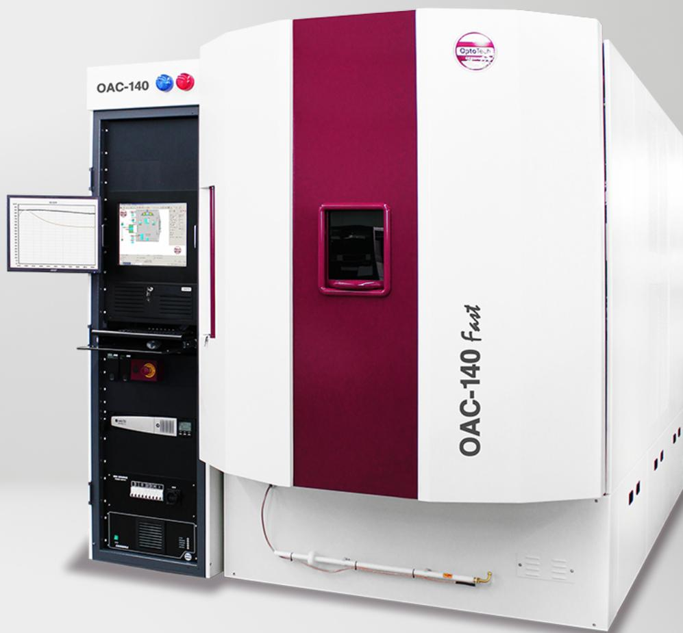
Die OptoTech's Beschichtungsmaschine OAC-140 Fast wird zum Auftragen von hochwertigem Antireflex-Beschichtungen (AR) und sogenannten Clean Coats (CC) auf ophthalmischen Linsen verwendet. Das OAC-Beschichtungssystem zeichnet sich durch die für OptoTech bekannte Produktqualität, einfache Handhabung und Zuverlässigkeit im täglichen Produktionsbetrieb aus.
