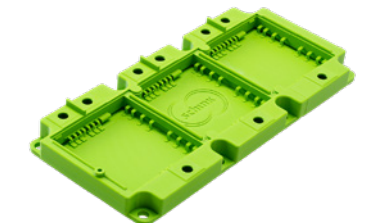
^ Standard IGBT Power Modul für die Leistungselektronik
